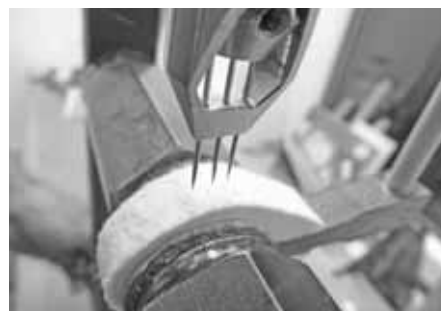
Vorintonieren – zusammen mit einem Metallbauer hat Christoph Bayha eine Lösung entwickelt, mit dem das „Intonieren“ der Wangen an den Hammerkopf-Filzen effizienter gelingt, als von Hand.
