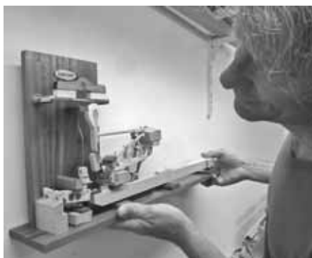
Christoph Bayha zeigt die Mechanik hinter einer Taste: Hier kann der Ton noch auf vielfältige Weise beeinflusst werden.
