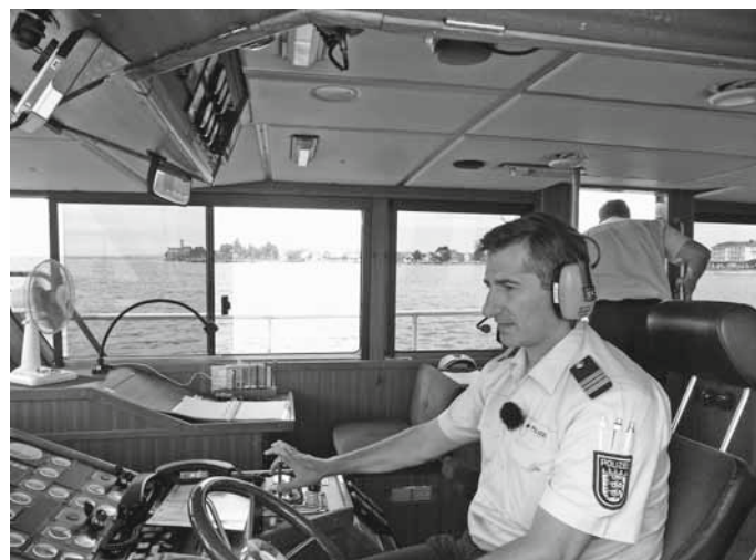
Präzisionsarbeit vor der Langenargener Bucht. Mit Radar und Tiefenmesser werden die Ankerplätze für die Bojen festgelegt: Bootsführer Aigner steht mit Thomas Damen über Kopfhörer in Funkkontakt. Wassertiefe 20 Meter. Bilder: tv
